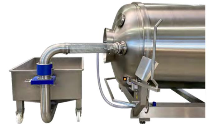
Vakuumbeschickung / vacuum loader
